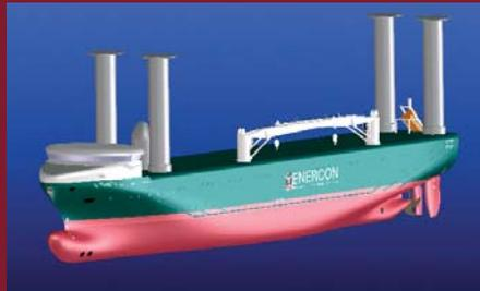
Das bereits 1853 entdeckte Funktionsprinzip der Flettner-Rotoren verspricht beim Einsatz auf Schiffen eine erhebliche Einsparung der Treibstoffkosten. An Bord angebrachte Zylinder nutzen die sie umströmende Luft, um die innerhalb der Zylinder installierten Rotoren in Bewegung zu bringen.
